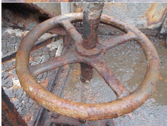
Poškození zavodňovacích ventilů – Zavodňovací klapky, vodítko
