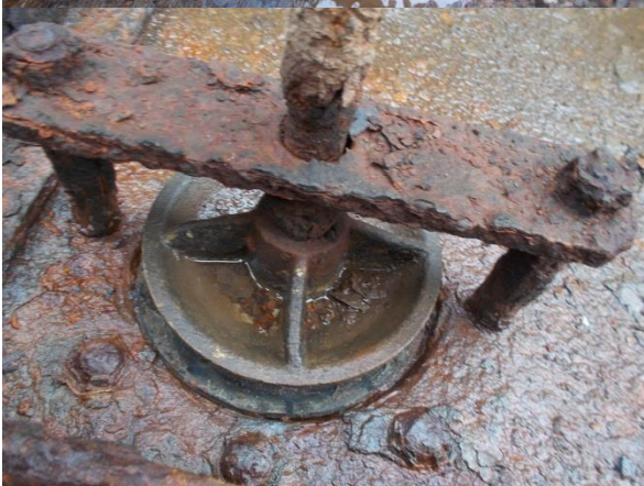
Poškození zavodňovacích ventilů – Zavodňovací klapky, vodítko
